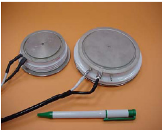
Fig. 4.5. 4500-V/800-A and 4500-V/1500-A GTOs [6].
