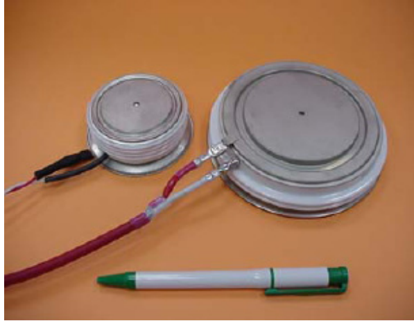
Fig. 4.4. 4500-V/800-A and 4500-V/1500-A thyristors [6].
