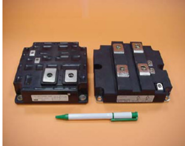
Fig. 4.8. 1700-V/1200-A and 3300-V/1200-A IGBT modules [6].
